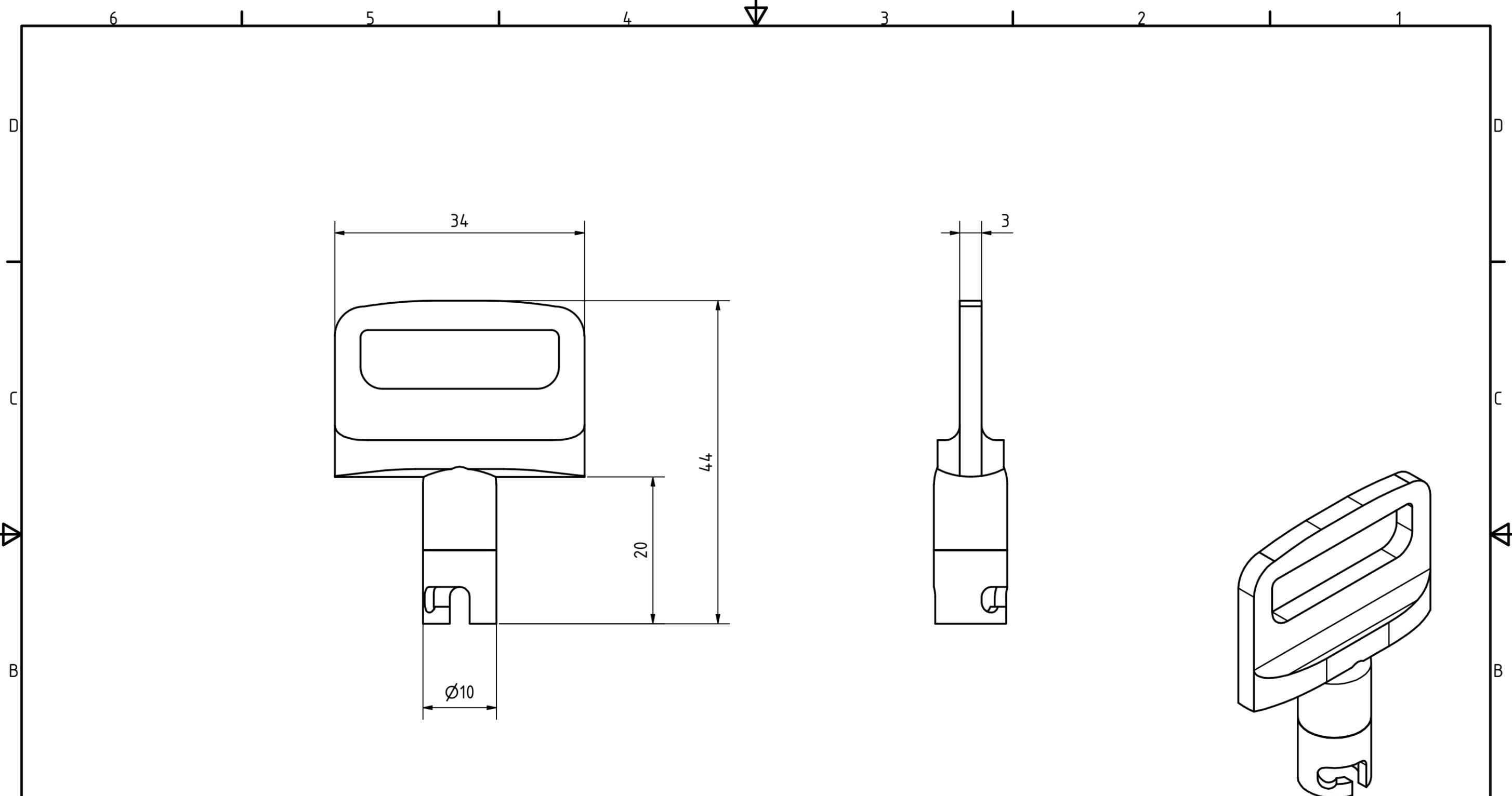
Werkstoff: Polyamid PA, glasfaserverstärkt
