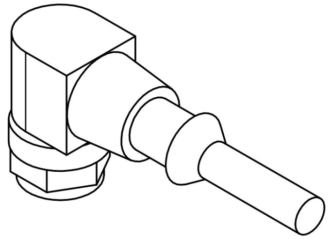
Kunststoffgriffteil (Gehäuse) Polyurethan-Elastomer TPU
