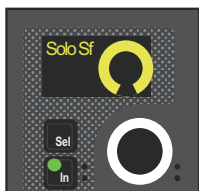
Automation Safe parameter on a CKM encoder
