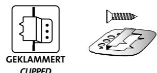
**Montage:** Rundprofil mit Null-Fuge mit Befestigungs-klammer Nr. 3
