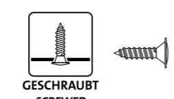
**Montage:** ter Hürne Spax Spezialschrauben 3 x 25 mm für Softprofil-Panneel oder Befestigungs-klammer Nr. 3
